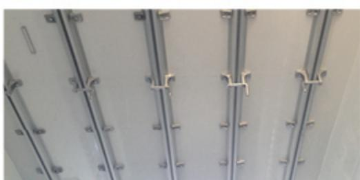
**Sürgülü Ray Sistemi:** Asılı olan kancalar raylar içinde serbestçe hareket edebilmekte. 5 sıra ray sistemi 250 adet kanca içermektedir. Sistem özellikle siğır eti taşımacılığında tercih edilmektedir.
